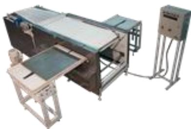
**АП-1** – автоматический укладчик изделий на противень - это специализированная машина, главной функциональной задачей которой является укладка продукции с ленты транспортера на противень.
